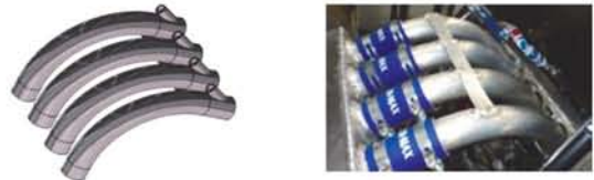
図7 インテークマニホールドのCAD図と完成品
