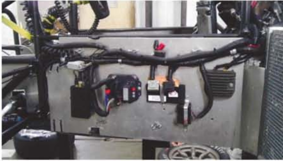
図 43 サイドウォールにマウントした電装部品とハーネス
