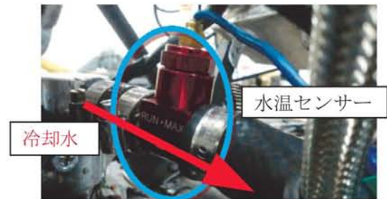
図 39 水温センサー取り付け図
