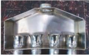
図10 サージタンク内部の様子
