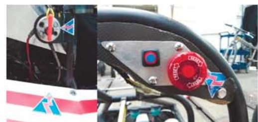
図 33 プライマリーマスタースイッチ(左)とコックピットマウントマスタースイッチ(右)
