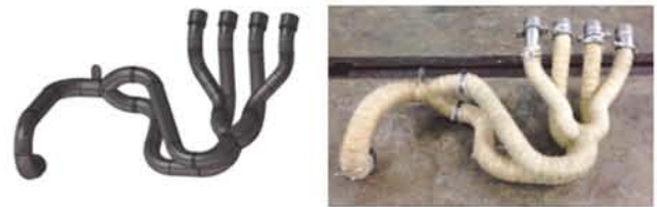
図8 エキゾーストマニホールドのCAD図と完成品
