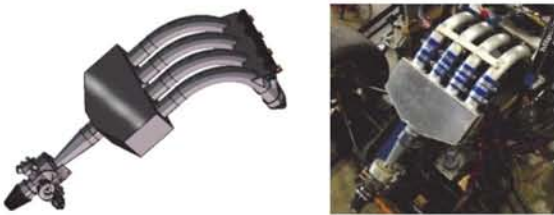
図 16 吸気系統アセンブリのCAD図と完成品
