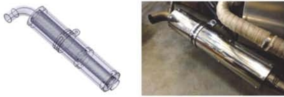
図 15 マフラーのCAD図と完成品
