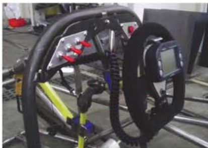
図 37 メーター装着図とカールコードの運用図
