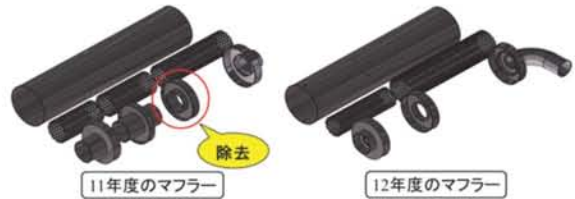
図13 2011年度と2012年度のマフラー内部比較のCAD図
