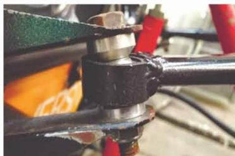
図7 ブラケットとベアリングケースのクリアランス
